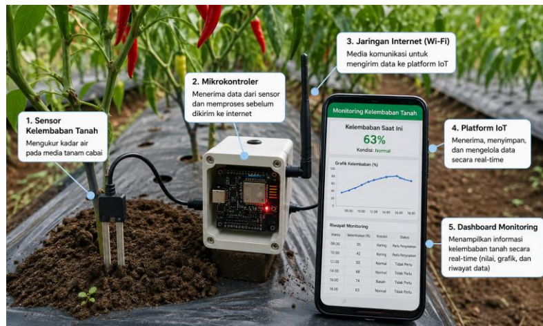
Gambar 3. Implementasi perangkat monitoring kelembaban tanah berbasis IoT pada media tanam cabai.
