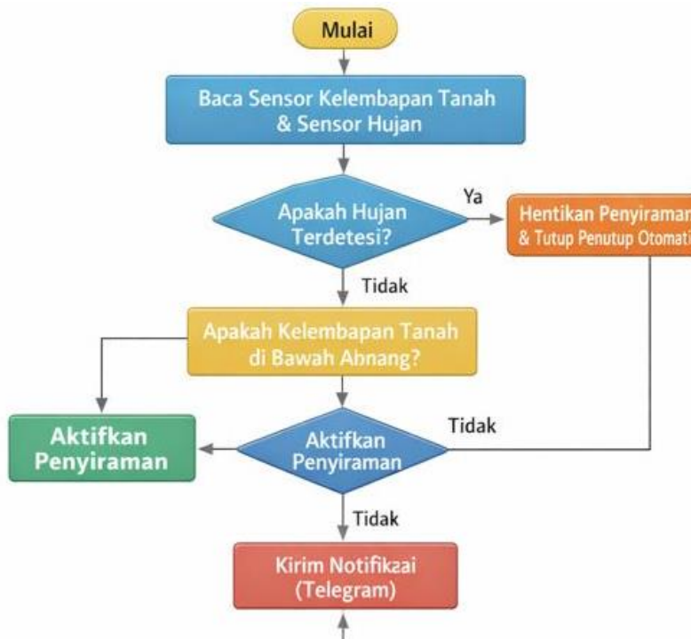
Gambar 2. Diagram alur logika kerja sistem penyiraman otomatis
